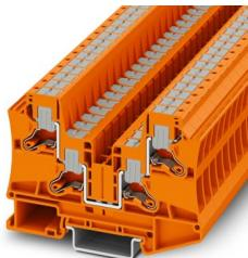
Morsetto passante, tensione nominale: 1000 V, corrente nominale: 41 A, numero di connessioni: 4, numero poli: 1, tipo di connessione: Connessione Push-in, Sezione di dimensionamento: 6 mm<sup>2</sup>, sezione: 0,5 mm<sup>2</sup> - 10 mm<sup>2</sup>, tipo di montaggio: NS 35/7,5, NS 35/15, colore: arancione
