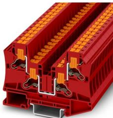
Morsetto passante, tensione nominale: 1000 V, corrente nominale: 41 A, numero di connessioni: 4, numero poli: 1, tipo di connessione: Connessione Push-in, Sezione di dimensionamento: 6 mm<sup>2</sup>, sezione: 0,5 mm<sup>2</sup> - 10 mm<sup>2</sup>, tipo di montaggio: NS 35/7,5, NS 35/15, colore: rosso
