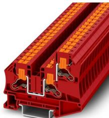
Morsetto passante, tensione nominale: 1000 V, corrente nominale: 41 A, numero di connessioni: 3, numero poli: 1, tipo di connessione: Connessione Push-in, Sezione di dimensionamento: 6 mm<sup>2</sup>, sezione: 0,5 mm<sup>2</sup> - 10 mm<sup>2</sup>, tipo di montaggio: NS 35/7,5, NS 35/15, colore: rosso
