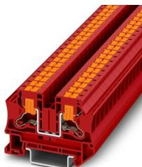
Morsetto passante, tensione nominale: 1000 V, corrente nominale: 41 A, numero di connessioni: 2, numero poli: 1, tipo di connessione: Connessione Push-in, Sezione di dimensionamento: 6 mm<sup>2</sup>, sezione: 0,5 mm<sup>2</sup> - 10 mm<sup>2</sup>, tipo di montaggio: NS 35/7,5, NS 35/15, colore: rosso
