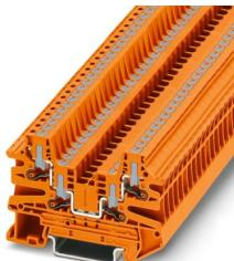
Morsetto passante, tensione nominale: 800 V, corrente nominale: 24 A, numero di connessioni: 4, tipo di connessione: Connessione Push-in, Sezione di dimensionamento: 2,5 mm<sup>2</sup>, sezione: 0,14 mm<sup>2</sup> - 4 mm<sup>2</sup>, tipo di montaggio: NS 35/7,5, NS 35/15, colore: arancione
