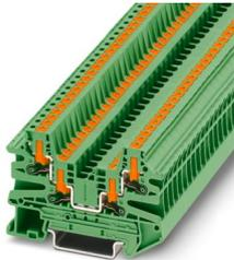
Morsetto passante, tensione nominale: 800 V, corrente nominale: 24 A, numero di connessioni: 4, tipo di connessione: Connessione Push-in, Sezione di dimensionamento: 2,5 mm<sup>2</sup>, sezione: 0,14 mm<sup>2</sup> - 4 mm<sup>2</sup>, tipo di montaggio: NS 35/7,5, NS 35/15, colore: verde
