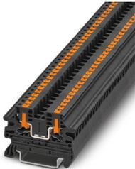
Morsetto passante, tensione nominale: 800 V, corrente nominale: 24 A, numero di connessioni: 2, numero poli: 1, tipo di connessione: Connessione Push-in, Sezione di dimensionamento: 2,5 mm<sup>2</sup>, sezione: 0,14 mm<sup>2</sup> - 4 mm<sup>2</sup>, tipo di montaggio: NS 35/7,5, NS 35/15, colore: nero
