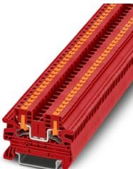
Morsetto passante, tensione nominale: 800 V, corrente nominale: 24 A, numero di connessioni: 2, numero poli: 1, tipo di connessione: Connessione Push-in, Sezione di dimensionamento: 2,5 mm<sup>2</sup>, sezione: 0,14 mm<sup>2</sup> - 4 mm<sup>2</sup>, tipo di montaggio: NS 35/7,5, NS 35/15, colore: rosso
