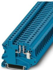
Morsetto sezionatore, Corrente e tensione sono determinate dalla spina impiegata., tensione nominale: 500 V, corrente nominale: 20 A, tipo di connessione: Connessione a vite, Sezione di dimensionamento: 4 mm<sup>2</sup>, sezione: 0,14 mm<sup>2</sup> - 6 mm<sup>2</sup>, montaggio: NS 35/7,5, NS 35/15, colore: blu
