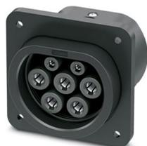
CHARX connect modular, Tipo 2, Presa di ricarica lato infrastruttura, 32 A , 480 V AC, Basic, senza fili singoli, squadrato, Montaggio sulla parete posteriore, Filettatura M5, custodia: nero, senza attuatore di bloccaggio, per la ricarica con corrente alternata (AC) di veicoli elettrici (EV), Logo PHOENIX CONTACT, IEC 62196-2, **IMPORTANTE!** Questa variante dell'articolo non prevede l'attuatore di bloccaggio.
