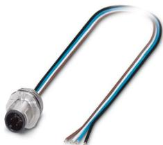
Connettore per apparecchi anteriore, Universale, 4-poli, Connnettore, diritto, M12-SPEEDCON, codifica: A, su estremità conduttore libera, Montaggio anteriore, M16 x 1,5, Fili singoli, lunghezza cavo: 0,5 m, 0,34 mm<sup>2</sup>, Filo in TPE, saldato
