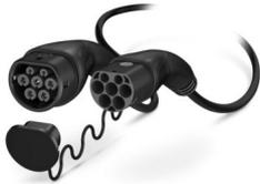
CHARX connect eco, Tipo 2, Cavo di ricarica AC mobile, 20 A permanente, 480 V AC, con connettori di ricarica lato veicolo e connettori di ricarica lato infrastruttura, cavi: 5 m, nero, dritto, con cappuccio di protezione, Logo PHOENIX CONTACT, IEC 62196-2, per la ricarica con corrente alternata (AC) di veicoli elettrici (EV), Il cappuccio di protezione compreso nella fornitura viene applicato al connettore di ricarica lato veicolo per il quale la norma prevede una protezione.
