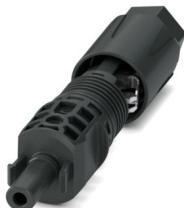
Connettore, Serie di prodotti: SUNCLIX, colore: nero, numero poli: 1, sezione del conduttore min.: 6 mm<sup>2</sup>, sezione del conduttore max.: 16 mm<sup>2</sup>, tensione di dimensionamento: 1500 V DC, corrente nominale: 60 A, Tipo di connessione: Molla, Tipo di connessione del contatto: Femmina, diametro cavo min.: 5,5 mm, diametro cavo max.: 10 mm
