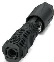
Connettore, Serie di prodotti: SUNCLIX, colore: nero, numero poli: 1, sezione del conduttore min.: 6 mm<sup>2</sup>, sezione del conduttore max.: 16 mm<sup>2</sup>, tensione di dimensionamento: 1500 V DC, corrente nominale: 60 A, Tipo di connessione: Molla, Tipo di connessione del contatto: Spina, diametro cavo min.: 5,5 mm, diametro cavo max.: 10 mm
