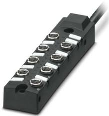
Scatola di distribuzione, applicazione: Standard Metallo, numero degli slot: 8, numero poli: 3, codifica: A, occupazione slot: singolo, segnalazione di stato: sì; connessione linea principale: Attacco fisso 180°, PUR/PVC, lunghezza cavo: 2,5 m, schermatura: no
