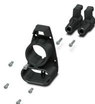
CHARX connect professional, CCS tipo 1, Kit di riparazione, Accessori, Montaggio a vite, custodia: nero, con supporto contatti in DC con parte anteriore integrata dei contatti in DC, con parte frontale del connettore sostituibile, con 5 viti a testa piatta M4X10 con impronta di sicurezza Torx (IPR TORX PLUS®), per la sostituzione della parte frontale dei connettori di ricarica lato veicolo, IEC 62196-3-1, SAE J1772, Sostituzione senza svuotare il liquido di raffreddamento
