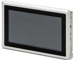
Panel PC (PPC) con grado di protezione IP65, schermo da 7 pollici, processore Intel® Celeron® N3350, memoria di lavoro da 4 GB, SSD mSATA da 64 GB e sistema operativo Windows 10 IoT Enterprise LTSC 2019.
