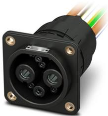
CHARX connect universal, DC GB/T, Presa di ricarica del veicolo, fino a 250 A in Boost mode, 250 A permanente, 1000 V DC, Fili singoli, lunghezza: 2 m, Montaggio sulla parete anteriore e posteriore, M6, custodia: nero, per la ricarica con corrente continua (DC), GB/T 20234.3-2015, La fornitura comprende un cappuccio di protezione per i contatti DC.
