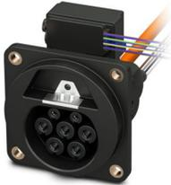
CHARX connect universal, AC GB/T, Presa di ricarica del veicolo, 32 A , 415 V AC, Fili singoli, lunghezza: 2 m, attuatore di bloccaggio: 12 V, 4 poli, Montaggio sulla parete anteriore e posteriore, M6, custodia: nero, per la ricarica con corrente alternata (AC) di veicoli elettrici (EV), GB/T 20234.2-2015
