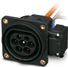
CHARX connect universal, AC tipo 2, Presa di ricarica del veicolo, 32 A , 250 V AC, Fili singoli, lunghezza: 2 m, attuatore di bloccaggio: 12 V, 4 poli, Montaggio sulla parete anteriore e posteriore, M6, custodia: nero, per la ricarica con corrente alternata (AC) di veicoli elettrici (EV), IEC 62196-2, La fornitura comprende un cappuccio di protezione per i contatti AC.
