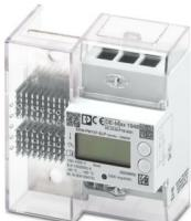
Contatore di energia in corrente continua con misurazione diretta fino a 1000 V / 650 A, con interfacce RS-485 per software di programmazione e verso il controllore per la ricarica, correzione delle perdite del cavo di ricarica, temperatura di esercizio fino a +80 °C, certificato secondo la legge di misurazione e calibrazione
