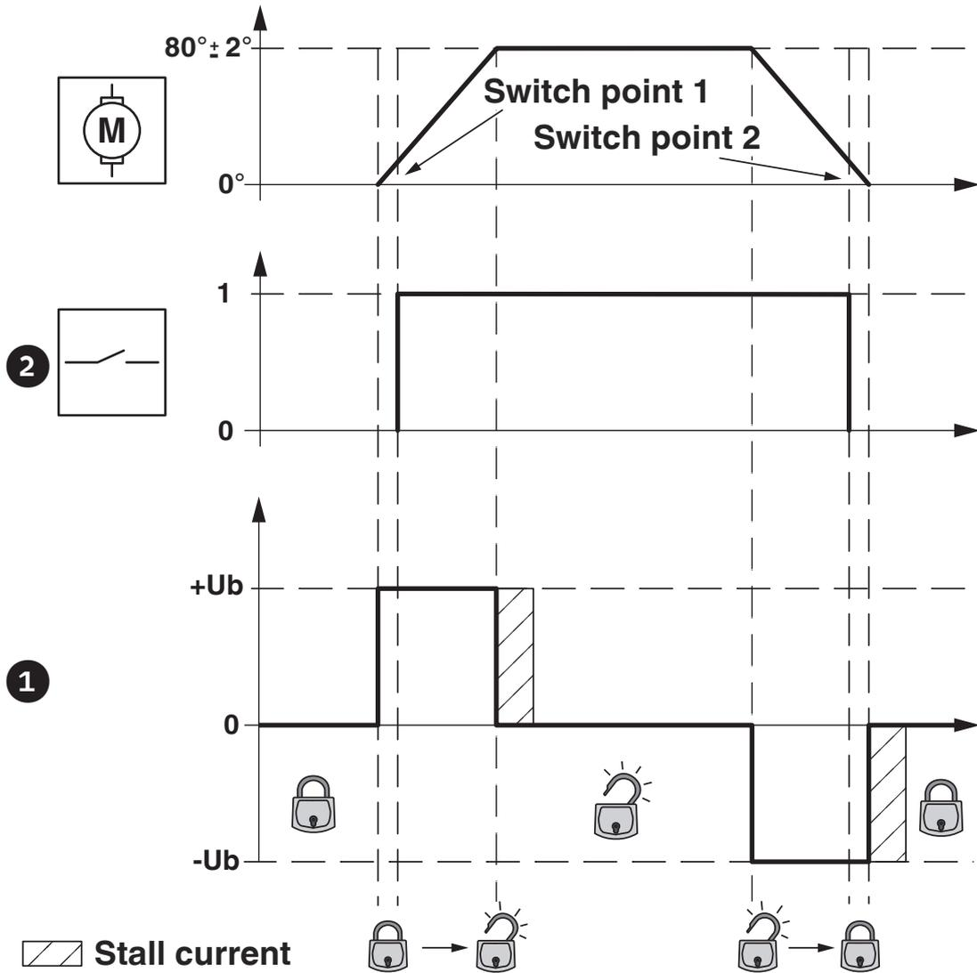
Stati di blocco dell'attuatore di bloccaggio
