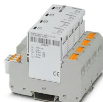
Scaricatore di corrente atmosferica/di sovratensione a innesto universale formato da varistore per reti di alimentazione di corrente trifase con N e PE separato (sistema a 5 conduttori: L1, L2, L3, N, PE), per livelli di protezione dai fulmini III e IV, con contatto di segnalazione remota. Collegamento delle linee tramite tecnologia di connessione Push-in.
