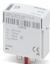
Spina di protezione contro la sovratensione tipo 2 con varistore di potenza per elemento base VAL-MS-PT, con controllo termico, segnalazione ottica di guasto. Esecuzione: 230 V AC
