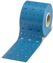
Segnacavi rilevabili, Rotolo, blu, in bianco, siglabile con: THERMOMARK E.300 (D)/600 (D), THERMOMARK ROLL 2.0, THERMOMARK ROLL, THERMOMARK ROLL X1, THERMOMARK ROLLMASTER 300/600, tipo di montaggio: Montaggio a fascette, diametro cavo:  $\geq 6$  mm, Numero dei cartellini singoli: 1000, altezza del campo di testo: 10 mm, larghezza del campo di testo: 30 mm
