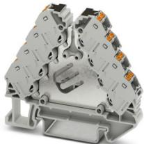
Ripartitore di potenziale, tensione nominale: 250 V, corrente nominale: 17,5 A, tipo di connessione: Connessione Push-in, 1., 2., 3. e 4. piano, Sezione di dimensionamento: 1,5 mm<sup>2</sup>, sezione: 0,14 mm<sup>2</sup> - 2,5 mm<sup>2</sup>, montaggio: NS 35/7,5, NS 35/15, colore: grigio, elementi di connessione colore: grigio
