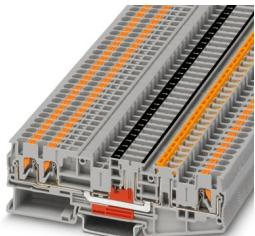
Morsetto con sezionatore a coltello, per la protezione contro le sovratensioni CLIXTRAB, tensione nominale: 400 V, corrente nominale: 20 A, tipo di connessione: Connessione Push-in, Sezione di dimensionamento: 2,5 mm<sup>2</sup>, sezione: 0,14 mm<sup>2</sup> - 4 mm<sup>2</sup>, montaggio: NS 35/7,5, NS 35/15, colore: grigio
