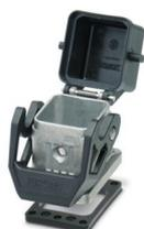
Custodia da incasso D7, con blocc. longitudinale, materiale: Pressofuso di alluminio, impermeabile, materiale coperchio: PA, altezza: 25,5 mm, connessione a vite per cavo: senza, coperchio di protezione: sì, Standard, per inserti porta contatti maschio
