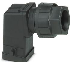
Custodia protettiva D7, per bloccaggio longitudinale, materiale: PA, uscite cavi: 1, laterali, M20, altezza: 54,5 mm, connessione a vite per cavo: con, Standard
