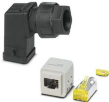
Set di connettori, numero poli: 8, CAT6<sub>A</sub>, materiale: PA, tipo di connessione: Connessione a crimpare, sezione di connessione: AWG 24- 27, uscita cavo: laterali, con inserto portacontatti RJ45, con guarnizione a intaglio
