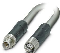
Cavo di alimentazione, 5-poli, PUR senza alogenati, grigio RAL 7001, Maschio diritto M12, codifica: L, su Connettore femmina diritto M12, codifica: L, lunghezza cavo: 5 m, per corrente continua fino a 16 A / 63 V
