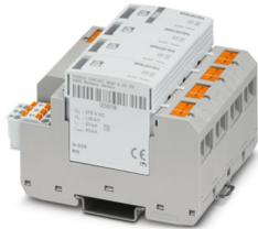
Scaricatore di sovratensione costituito da elemento base con tecnologia di connessione Push-in, contatto di segnalazione remota Push-in e spine estraibili, per montaggio su NS 35/7,5. Tensione nominale: 230 V AC, circuito 3+1
