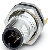
Connettore per apparecchi posteriore, 5-poli, Connettore, diritto, M12-SPEEDCON, codifica: A, Montaggio posteriore, Pg9, Codoli, L'articolo è senza piombo secondo la direttiva RoHS II senza eccezione 6c (Pb < 0,1 %)
