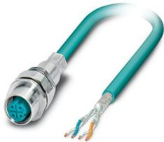
Connettore per apparecchi anteriore, Ethernet CAT5 (100 MBit/s), Ethernet, 4-poli, PUR, azzurro mare RAL 5021, schermata, Femmina, diritto, M12, codifica: D, su estremità conduttore libera, Montaggio anteriore, Collegamento del cavo, lunghezza cavo: 0,5 m, Ethernet flessibile CAT5, a 2 coppie, L'articolo è senza piombo secondo la direttiva RoHS II senza eccezione 6c (Pb < 0,1 %)
