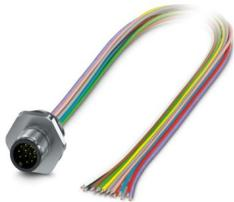
Connettore per apparecchi anteriore, Universale, 12-poli, Connettore, diritto, M12-Standard, codifica: A, su estremità conduttore libera, Montaggio anteriore, M16 x 1,5, Fili singoli, lunghezza cavo: 0,5 m, 0,14 mm<sup>2</sup>, Filo in TPE, saldato, L'articolo è senza piombo secondo la direttiva RoHS II senza eccezione 6c (Pb < 0,1 %)
