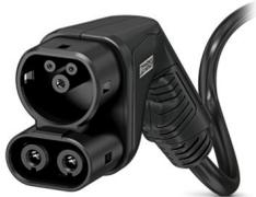
CHARX connect compact, CCS tipo 2, Cavo di ricarica in DC, 40 A permanente, 1000 V DC, con connettore di ricarica lato veicolo ed estremità aperta, cavi: 6 m, nero, diritto, con contatto PP collegato, con sensori di temperatura analogici, Logo PHOENIX CONTACT, IEC 62196-3, per la ricarica con corrente continua (DC) di veicoli elettrici (EV)
