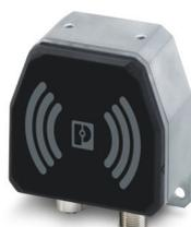
NearFi-Base, accoppiatore Ethernet in tempo reale senza contatto, 100 MBit/s, portata ≤40 mm, connessione a vite M12, IP65, combinabile con NEARFI D ETH R. Incompatibile con NEARFI 2000 (Nuovo)
