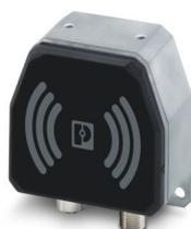
Base NearFi, accoppiatore Ethernet di energia e in tempo reale senza contatto, 50 W (US), 100 MBit/s, portata  $\leq 10$  mm, connessione a vite M12, IP65, combinabile con NEARFI PD 2A ETH R. Incompatibile con NEARFI 2200 (Nuovo)
