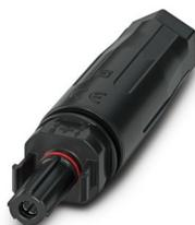
Connettore, Serie di prodotti: BPP, colore: rosso/nero, numero poli: 1, sezione del conduttore min.: 2,5 mm<sup>2</sup>, sezione del conduttore max.: 6 mm<sup>2</sup>, tensione di dimensionamento: 1500 V DC, corrente nominale: 35 A, Tipo di connessione: Molla, Tipo di connessione del contatto: Femmina, diametro cavo min.: 5 mm, diametro cavo max.: 8 mm
