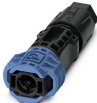
Connettore, Serie di prodotti: BPP, colore: blu/noir, numero poli: 1, sezione del conduttore min.: 2,5 mm<sup>2</sup>, sezione del conduttore max.: 6 mm<sup>2</sup>, tensione di dimensionamento: 1500 V, corrente nominale: 38 A, Tipo di connessione: A crimpare, Tipo di connessione del contatto: Spina, diametro cavo min.: 5 mm, diametro cavo max.: 8 mm
