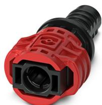
Connettore per apparecchi anteriore, Serie di prodotti: BPP, colore: rosso/nero, numero poli: 1, sezione del conduttore min.: 2,5 mm<sup>2</sup>, sezione del conduttore max.: 6 mm<sup>2</sup>, tensione di dimensionamento: 1500 V DC, corrente nominale: 26 A, Tipo di connessione: A crimpare, Tipo di connessione del contatto: Spina
