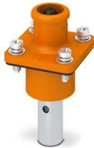
Connettore, Serie di prodotti: BPC, colore: arancione, numero poli: 1, sezione del conduttore min.: 16 mm<sup>2</sup>, sezione del conduttore max.: 25 mm<sup>2</sup>, tensione di dimensionamento: 1500, corrente nominale: 120 A, Tipo di connessione: A crimpare, Tipo di connessione del contatto: Spina
