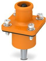
Connettore, Serie di prodotti: BPC, colore: arancione, numero poli: 1, sezione del conduttore min.: 35 mm<sup>2</sup>, sezione del conduttore max.: 70 mm<sup>2</sup>, tensione di dimensionamento: 1500, corrente nominale: 250 A, Tipo di connessione: Attacco a vite / a saldare, Tipo di connessione del contatto: Spina
