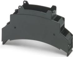
Custodia per guide DIN per l'impiego nei ripartitori di installazione a norma DIN 43880, Parte superiore della custodia per morsetti per circuiti stampati con connessione a vite, larghezza: 17,8 mm, altezza: 89,7 mm, profondità: 53,4 mm, colore: nero (simili RAL 9005)
