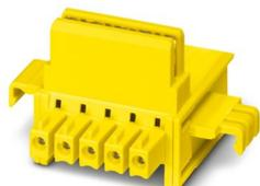
Connettore bus per guide DIN, corrente nominale: 8 A (contatti paralleli), tensione di dimensionamento (III/2): 125 V, numero di poli: 5, passo: 3,81 mm, colore: giallo, montaggio: guida DIN, articolo con contatti dorati, connettore bus per il collegamento con custodie per l'elettronica, 5 contatti paralleli
