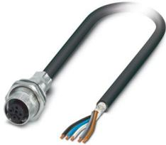
Connettore per apparecchi posteriore, 5-poli, PUR senza alogenati, grigio-nero RAL 7021, schermata, Femmina, diritto, M12-Bloccaggio esterno Push-Pull, codifica: A, su estremità conduttore libera, Montaggio posteriore, M16 x 1,5, Collegamento del cavo, lunghezza cavo: 2 m, 0,34 mm<sup>2</sup>, PUR senza alogenati nero
