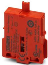
Contattore per interruttori di arresto di emergenza modulari con contatto ad apertura forzata (NC) per il disinserimento sicuro, indicato in combinazione con un adeguato apparecchio di misurazione fino a PL e (EN ISO 13849-1), SIL 3 (EN IEC 62061)
