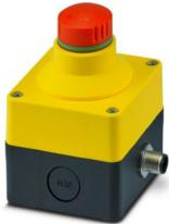
Interruttore di arresto di emergenza nella custodia IP65, indicato in combinazione con un adeguato apparecchio di misurazione fino a PL e (EN ISO 13849-1), SIL 3 (EN 62061), montaggio a superficie, connessione M12 a 5 poli
