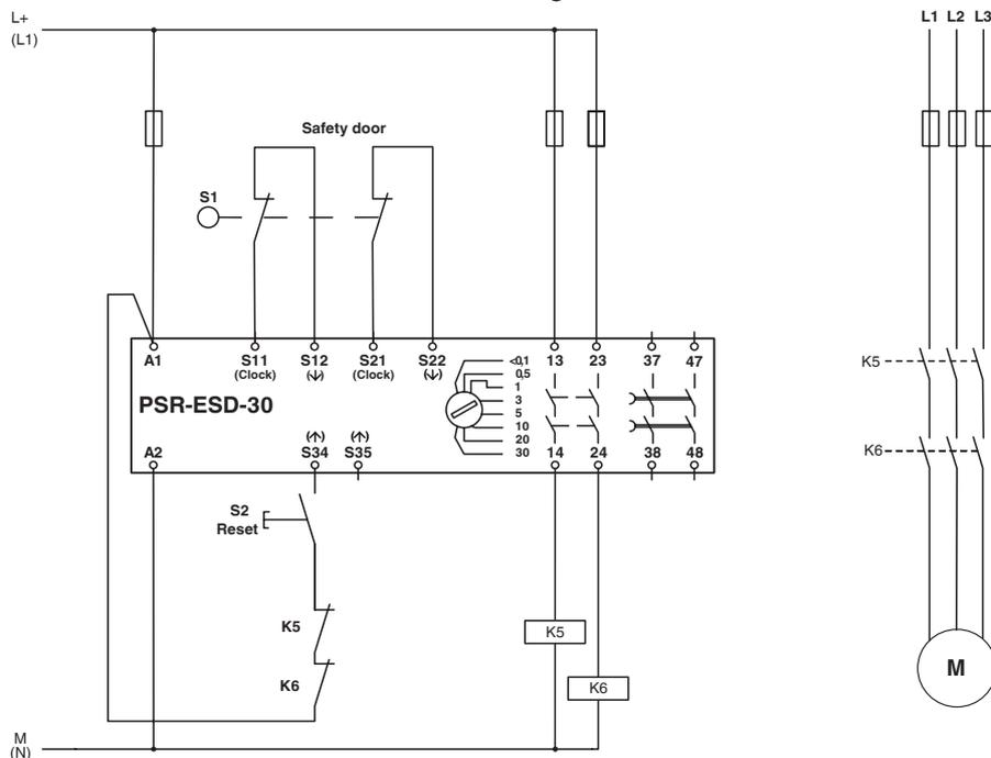
Controllo fincorsa ripari a due canali
