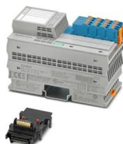
Axioline P, Modulo di ingresso analogico, Ingressi analogici passivi: 8 (HART), 0 mA ... 20 mA, 4 mA ... 20 mA, tecnica di connessione: 2 conduttori, velocità di trasmissione nel bus locale: 100 MBit/s, Funzionalità HART, sicurezza intrinseca, grado di protezione: IP20, compresi modulo di base bus e connettori Axioline P
